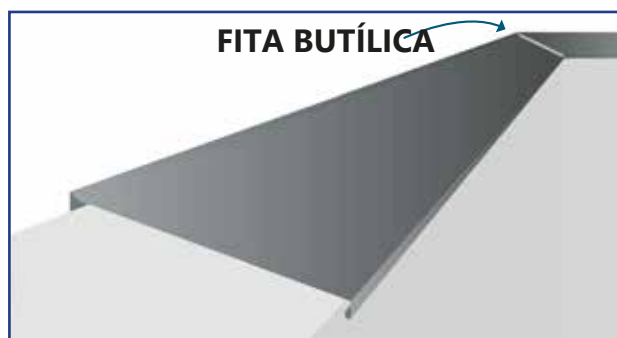
4 - Colocação da fita butílica na junção dos dois rufos
